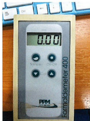
ภาพที่ 2.2-6 เครื่องมือตรวจวัดสารฟอร์มัลดีไฮด์แบบมือถือ
